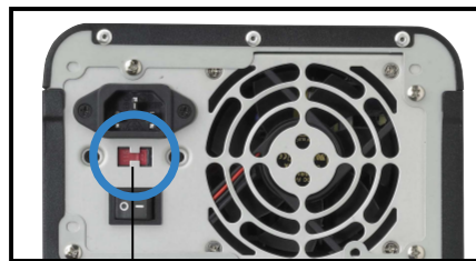
Переключатель напряжения 115 В/230 В
